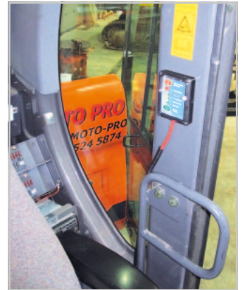
Keskusyksikkö sijoitettuna Doosanin ohjaamon sivupalkkiin, jossa se ei vie paljoo hyttitilaa.
