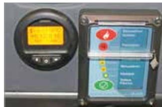
Rengaspaineen ja lämpötilan valvontajärjestelmän mittari (vas.) sijoitetaan ohjaamoon. Vieressä automaattisen palonsammutusjärjestelmän hallintalaitte. Sammutus voidaan laukaista myös manuaalisesti rikkomalla sinetti ja painamalla palohälytysnäppäintä tai avaamalla painepullon venttiili.
