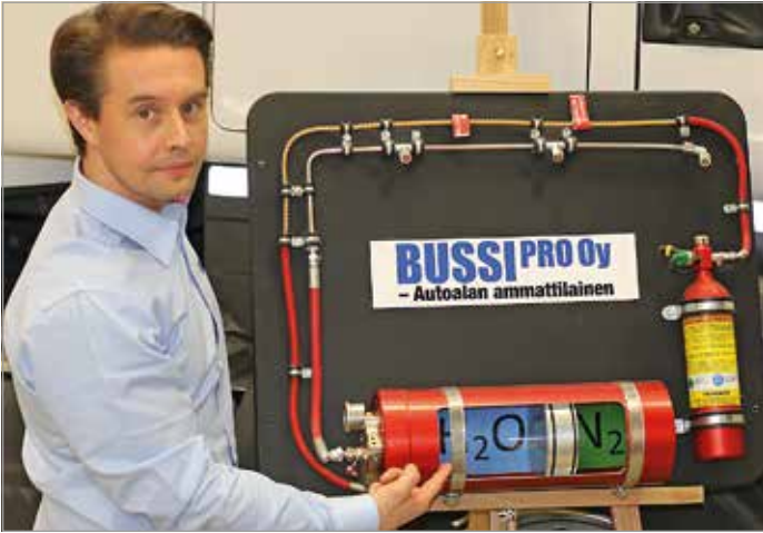
BussiPro Oy:n toimitusjohtaja Jussi Rauniston mielestä vesi on paras sammuteaine ajoneuvopaloissakin. Kuvassa on automaattisen palonsammutusjärjestelmän kaikki osat.
